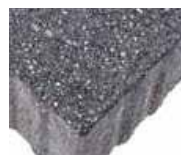
ferro R13 | USRV 65 otryskaný ocelovými kuličkami
