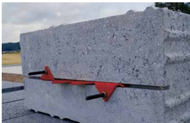
Kotevní lišta je vložena do drážky na spodní straně. Prvek je pak rovnoměrně zasazen do štěrkového lože a výstupky na liště brání jeho posuvu.
