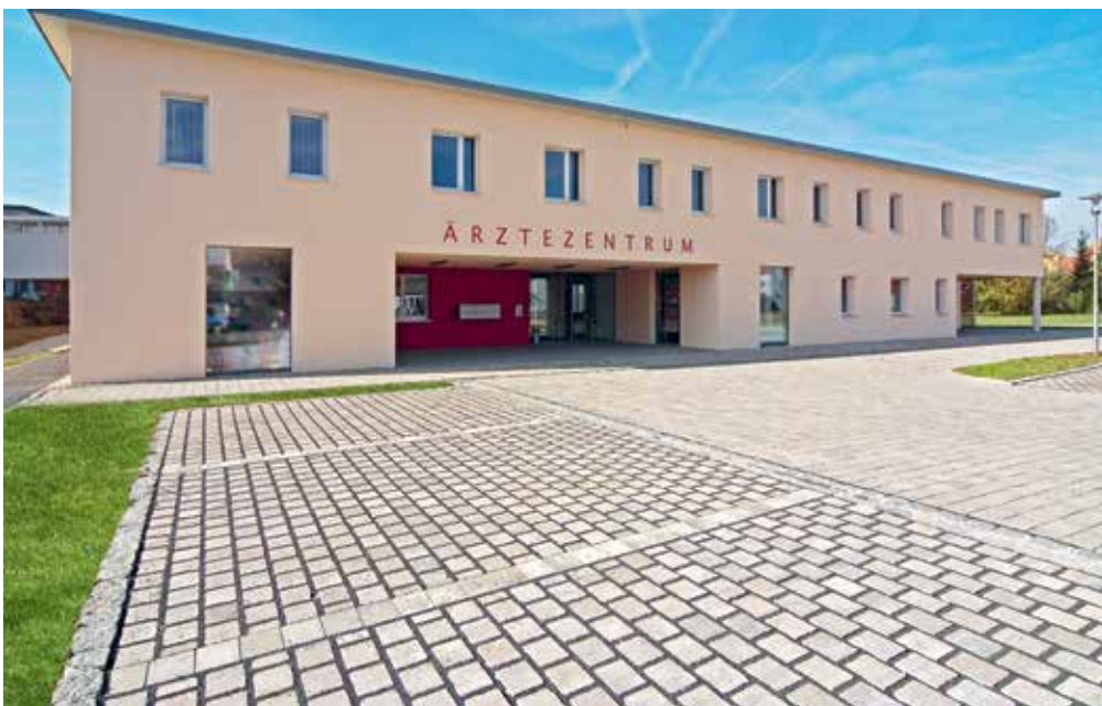
GDM.VIA stone kámen se spárou nativo lasturové vápno tónovaná 21/17,5/10 cm s 26 mm spára
