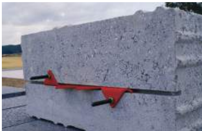
Kotevní lišta je vložena do drážky na spodní straně. Prvek je pak rovnoměrně zasazen do štěrkového lože a výstupky na liště brání jeho posunu.
